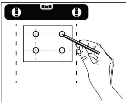
**Bohrschablone mit Wasserwaage ausrichten und Bohrlöcher markieren.**
