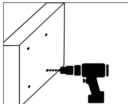
**Markierte Punkte mit 8er Bohrer bohren.**
