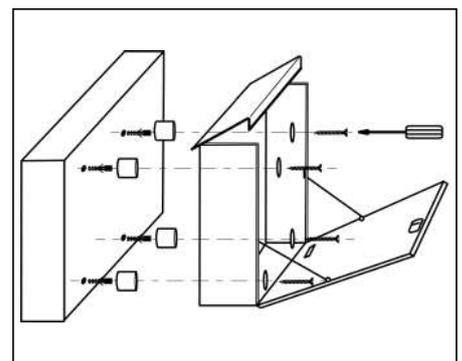
**Kasten an die Wand schrauben. Je Bohrloch einen Dübel, eine Distanz, eine Unterlegscheibe und eine Schraube verwenden.**
