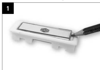
Taster Lira Zwischen Tastenrahmen und Namensschild mit einem Bleistift die Abdeckung austrasten. Einlage einlegen und Abdeckung wieder einrasten.
