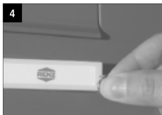
Entriegelung des Namensschildes durch Eindrücken des Entriegelungsschlüssels in die Bohrung auf der rechten Seite des Namensschildes.
