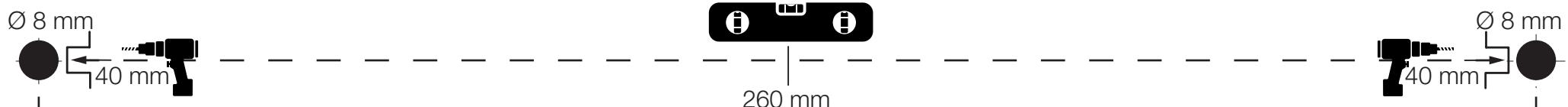
**DK** Brevkassen skal justeres nøjagtigt horisontalt og vertikalt, så siderne ikke bliver skævt og forårsager utætheder. Hvis monteringen ikke foretages på et egnet stativsystem (ikke inkluderet i leveringsomfanget), skal den medfølgende boreskabelon anvendes.
